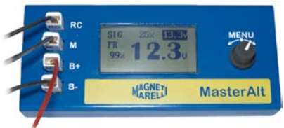
URZĄDZENIE MASTERALT FIRMY MAGNETI MARELLI DO TESTOWANIA REGULATORÓW NAPIĘCIA
