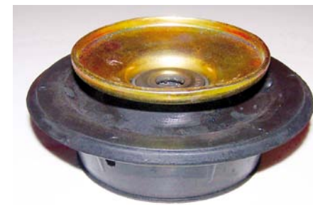
GUMOWA CZĘŚĆ ŁOŻYSKOWANIA ZAPOBIEGAJĄCA PRZENOSZENIU DRGAŃ ZAWIESZENIA NA KONSTRUKCJĘ NOŚNĄ POJAZDU
