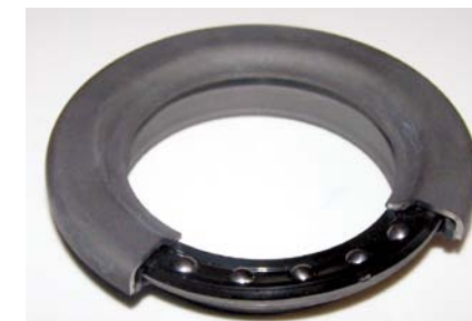
ODMIANY KONSTRUKCYJNE ŁOŻYSKOWANIA KOLUMNY MCPHERSONA: Z LEWEJ – ŁOŻYSKO WZDŁUŻNE, Z PRAWYJ – SKOŚNE
