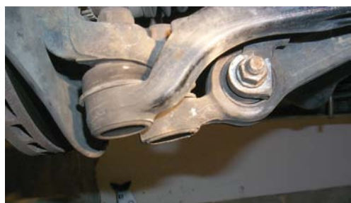
TULEJA METALOWO-GUMOWA OSADZONA W WAHACZU
