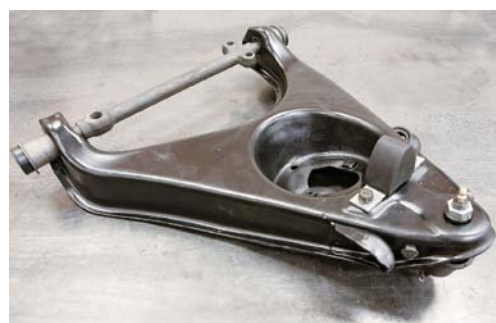
WAHACZ WYPOSAŻONY W PODWÓJNE POZIOME ŁOŻYSKOWANIE GUMOWE Z METALOWYMI OSŁONAMI
