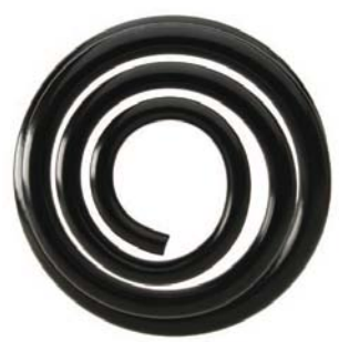
SPRĘŻYNA TYPU MINIBLOCK MA PROGRESYWNĄ CHARAKTERYSTYKĘ DZIĘKI ZMIENNEMU PRZEKROJOWI DRUTU
