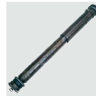
AMORTYZATOR ZANIECZYSZCZONY PREPARATEM DO OCHRONY PODWOZIA
