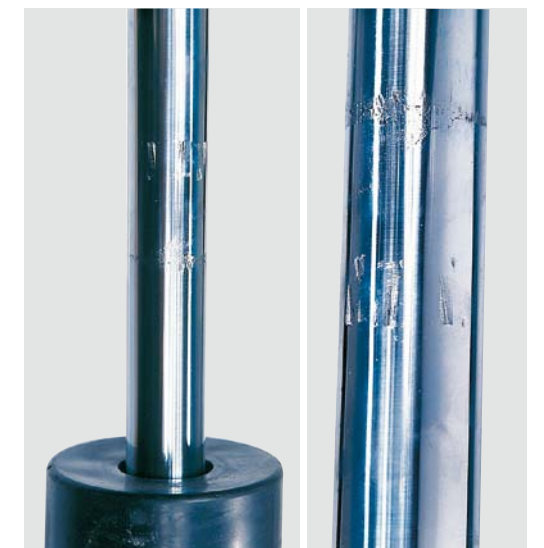
UBYTKI I WŻERY NA GŁADZI TŁOCZYSKA
