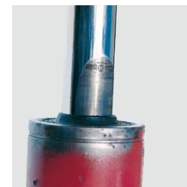
PRZETRĄTA WARSZTWA CHROMU POKRYWAJĄCEGO TŁOCZYSKO
