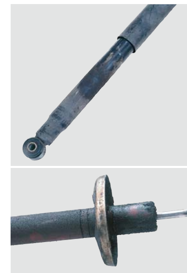
NIEZNACZNE (U GÓRY) I OBFITE ŚLADY OLEJU NA AMORTYZATORZE
