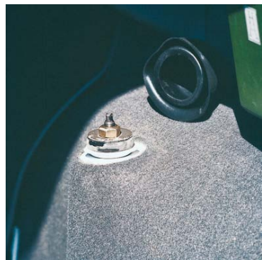
PRZYCZYNA HAŁĄŚLIWEJ PRACY GÓRNEGO ZAMOCOWANIA AMORTYZATORA UJAWNIA SIĘ CZĘSTO JUŻ PO ZDJĘCIU OCHRONNEGO KAPTURKA
