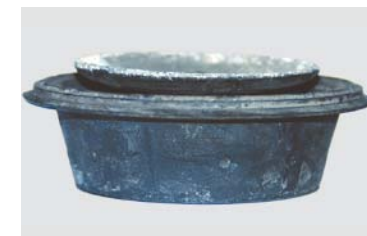
ŁOŻYSKO KOLUMNY MCPHERSONA, U GÓRY: SPRAWNE, U DOŁU: ZUŻYTE
