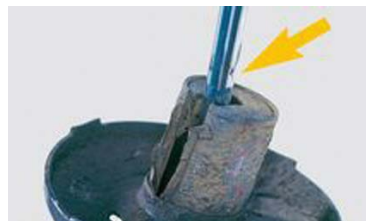
AMORTYZATOR ZNISZCZONY NA SKUTEK ZGIĘCIA TŁOCZYSKA
