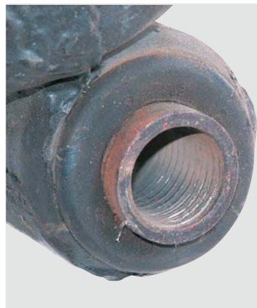
ODCISK GWINTU ŚRUBY WEWNĄTRZ TULEI METALOWO-GUMOWEJ
