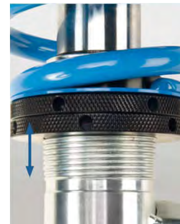
KLASYCZNE SYSTEMY ZMIANY PARAMETRÓW ZAWIESZEŃ STOSOWANE PRZEZ FIRMĘ BILSTEIN. Z LEWEJ – MECHANICZNA REGULACJA SPIRALNEJ SPRĘŻYNY. Z PRAWEJ – ELEKTRONICZNE STEROWANIE SIŁY TŁUMIENIA AMORTYZATORA
