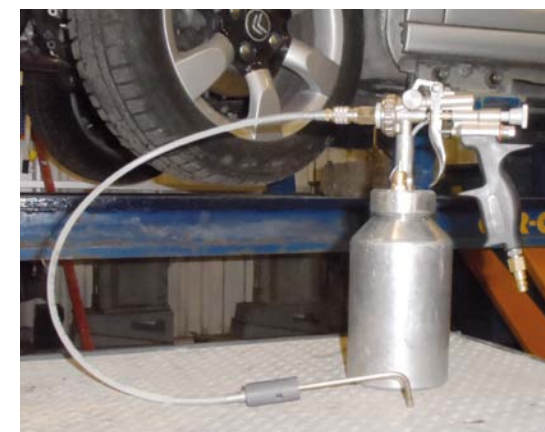
DO PŁYTKICH SZEROKICH PRZESTRZENI (PRZYKŁAD Z LEWEJ) UŻYWA SIĘ KĄTOWEJ KOŃCÓWKI ROZPYLAJĄCEJ Z PORĘCZNYM UCHWYTEM
