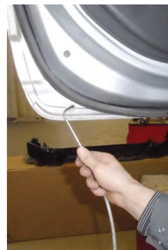
DO PŁYTKICH SZEROKICH PRZESTRZENI (PRZYKŁAD Z LEWEJ) UŻYWA SIĘ KĄTOWEJ KOŃCÓWKI ROZPYLAJĄCEJ Z PORĘCZNYM UCHWYTEM
