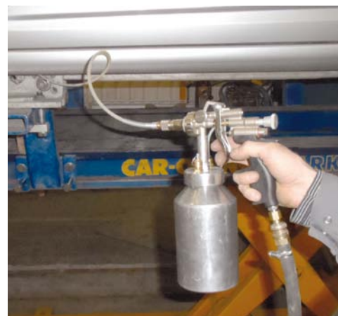
PISTOLET PNEUMATYCZNY DO APLIKACJI ANTYKOROZYJNYCH PREPARATÓW ML. DŁUGI APLIKATOR ELASTYCZNY Z PROSTĄ KOŃCÓWKĄ ROZPYLAJĄCĄ SŁUŻY DO KONSERWACJI WNĘTRZ GŁĘBOKICH WĄSKICH PROFILÓW, NP. PROGÓW (ZDJĘCIE Z PRAWY)
