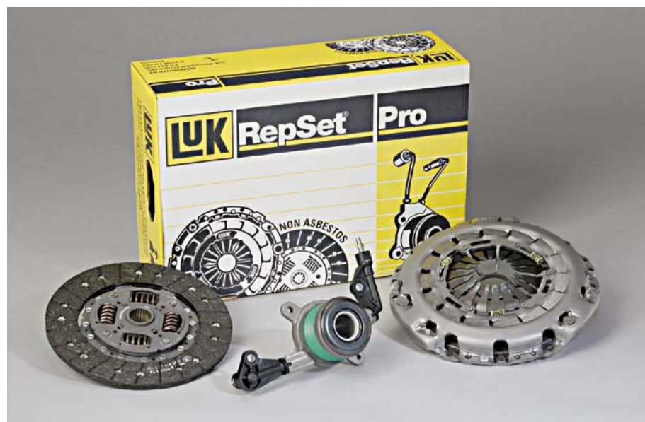
KOMPLET NAPRAWCZY LUK ZAWIERAJĄCY TARCZĘ SPRZĘGŁOWĄ, CENTRALNY WYSPRZĘGLIK I DOCISK SPRZĘGŁA
