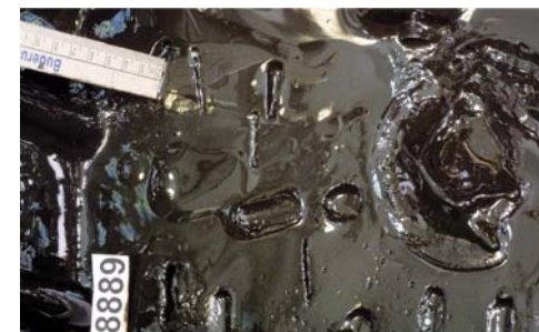
NAWET NAJLEPSZY OLEJ MOŻE PRZYBRAĆ TAKĄ POSTAĆ, JEŚLI NIE ZOSTANIE WYMIENIONY W ODPOWIEDNIM TERMINIE
