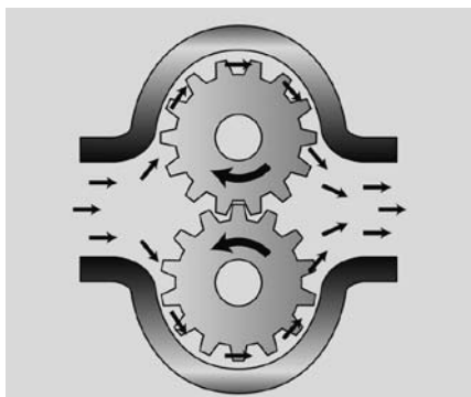
OLEJ O ZBYT NISKIEJ LEPKOŚCI NIE USZCZELNIA DOSTATECZNIE POMPĘ. CO ZMNIJSZA WYDAJNOŚĆ SMAROWANIA
