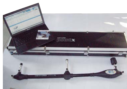
WSPÓŁPRACA PRZYRZĄDU POINT X Z KOMPUTEREM WYPOSAŻONYM W OPROGRAMOWANIE VISION2
