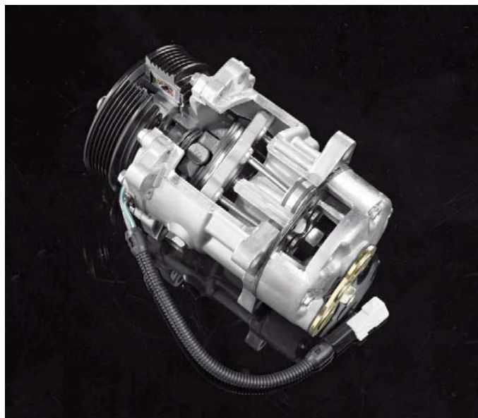
PRZEKRÓJ UKAZUJĄCY WEWNĘTRZNĄ BUDOWĘ SPRĘŻARKI UŚWIADAMIA, JAK BARDZO JEJ KONSTRUKCJA SZKODZIĆ MOGĄ WSZELKIE ZANIECZYSZCZENIA
