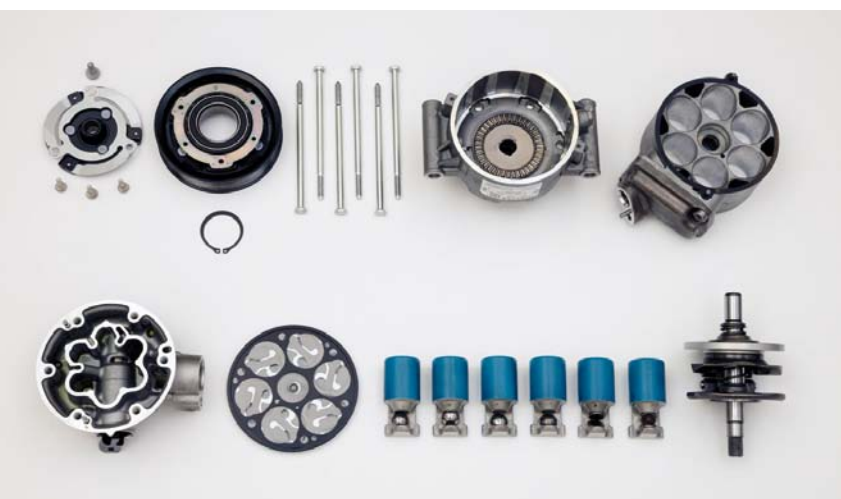
SPRĘŻARKA DELPHI CVC ROZŁOŻONA NA CZĘŚCI
