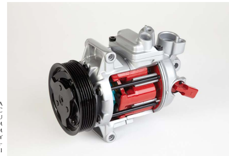
SPRĘŻARKA DELPHI CVC W PRZEKROJU UKAZUJĄCYM MECHANIZM KRZYWKOWY Z POPYCHACZAMI
