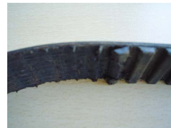
ROZWULKANIZOWANIE STRUKTURY – PASEK „PUCHNIE”
