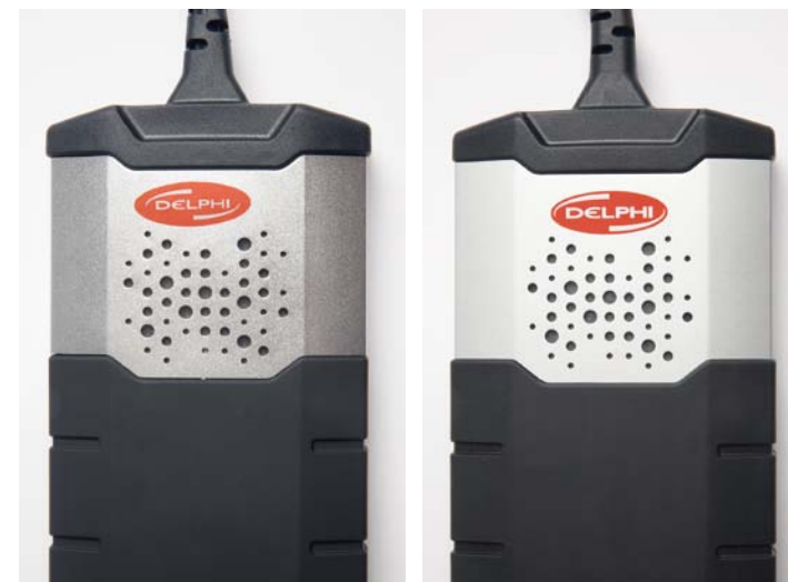
WYKOŃCZENIE Z MATOWEGO ALUMINIUM ZASTĄPIONO W PODRÓBCE BŁYSZCZĄCĄ POWŁOKĄ MALARSKĄ
