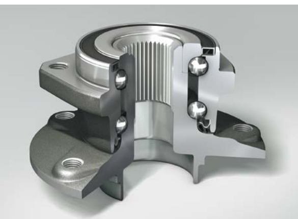
OFEROWANY PRZEZ NSK KOMPLEKSOWY MODUŁ PIASTY, W KTÓRYM WEWNĘTRZNY PIERSIEŃ DWURZĘDOWEGO ŁOŻYSKA KULKOWEGO ZINTEGROWANY ZOSTAŁ Z WIELOWYPUSTEM PÓŁOSI I KOŁNIERZEM DO MOCOWANIA KOŁA. ZEWNĘTRZNY ZAŚ Z PŁYTĄ MONTAŻOWĄ PRZYKRĘCANĄ DO ZAWIESZENIA POJAZDU
