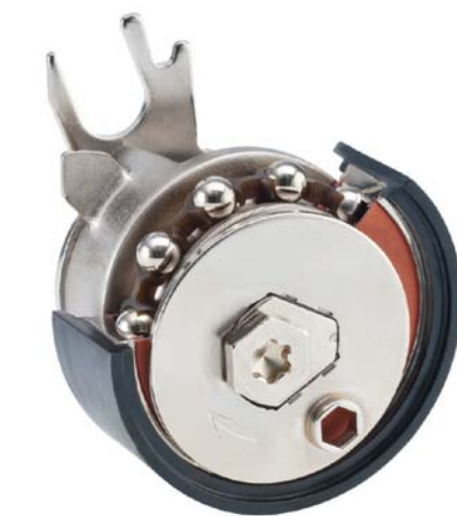
BUDOWA NAPINACZA MECHANICZNEGO. PRZEKRÓJ UWIDACZNI JEDNORZĘDOWE ŁOŻYSKO KULKOWE I OSADZONĄ NA NIM POLIAMIDOWĄ ROLKĘ DOCISKOWĄ
