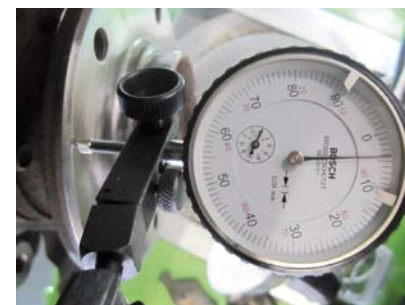
PRZED ZAMONTOWANIEM NOWEJ TARCZY HAMULCOWEJ PŁASZCZYNĘ PRZYLGOWĄ PIASTY NALEŻY DOKŁADNIE OCZYŚCIĆ Z POKRYWAJĄCYCH JĄ OSADÓW
