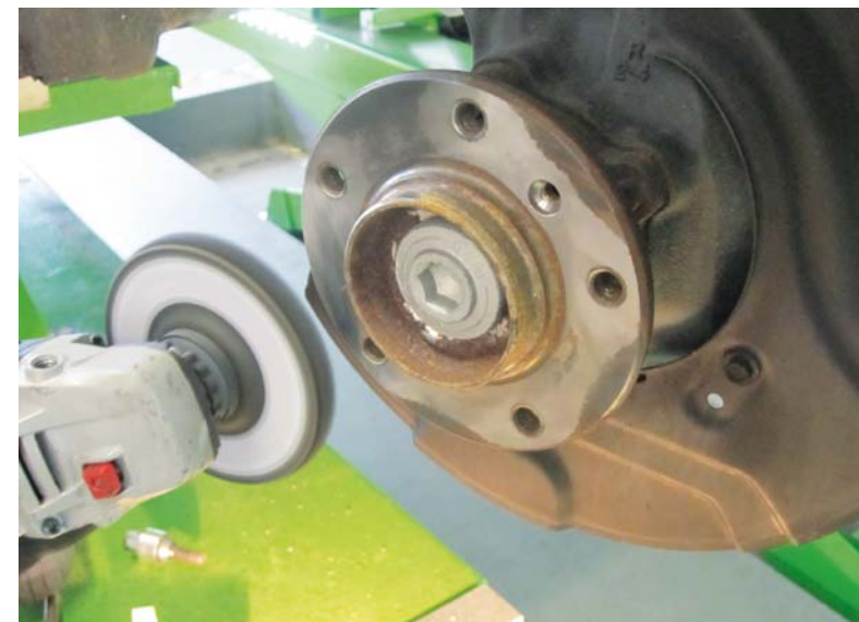
PRZED ZAMONTOWANIEM NOWEJ TARCZY HAMULCOWEJ PŁASZCZYNĘ PRZYLGOWĄ PIASTY NALEŻY DOKŁADNIE OCZYŚCIĆ Z POKRYWAJĄCYCH JĄ OSADÓW
