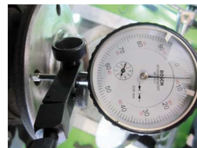
TZW. PRZECIĄgniĘCIE KOŁNIERZA PIASTY WYKRYWA SIĘ ZA POMOCĄ CZUJNIKA ZEGAROWEGO PRZEZ PORÓWNANIE JEGO MINIMALNYCH WSKAZAŃ Z MAKSYMALNYMI. W TYM WYPADKU RÓŻNICA WYNOŚI 0,02 MM I JUŻ MOŻE POWODOWAĆ WADLIWĄ PRACĘ HAMULCA
