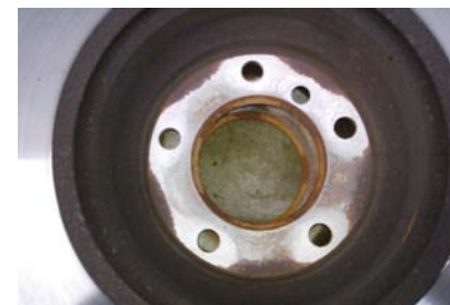
ŚLADY NIEPRAWIDŁOWEJ WSPÓŁPRACY TARCZY HAMULCOWEJ Z PIASTĄ PRZECIĄgniĘTĄ PRZEZ NADMIERNE DOKRĘCANIE ŚRUB MOCUJĄCYCH KOŁO
