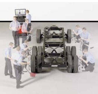
SZYBKI POMIAR KĄTÓW ISTOTNYCH DLA PRAWIDŁOWEGO ZUŻYWANIA SIĘ OPON
