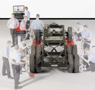
PROCEDURA BADANIA GEOMETRII NAJNOWSZYM SYSTEMEM HUNTER I ODPOWIADAJĄCE JEJ CZYNNOŚCI DIAGNOSTY
