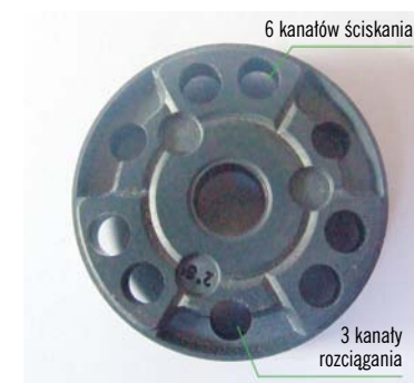
4. TŁOK AMORTYZATORA SACHS Z RÓWNOLEGLYMI KANAŁAMI, Z KTÓRYCH TRZY ZAPEWNIĄJĄ PRZEPŁYW OLEJU PRZY ROZCIĄGANIU, A SZEŚĆ – PRZY ŚCISKANIU
