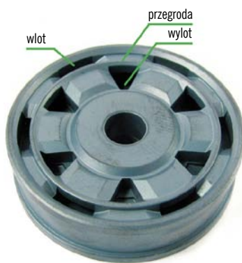
11. TŁOK BILSTEIN Z KRZYŻUJĄCYMI SIĘ KANAŁAMI (ZEWNĘTRZNE PO JEDNEJ STRONIE TŁOKA SĄ WEWNĘTRZNYMI PO DRUGIEJ). ZAWÓR I BY-PASS ROZDZIELA PIERŚCIEŃ, WSPÓŁPRACUJĄCY Z PIERWSZĄ PŁYTKĄ ZAWORU
