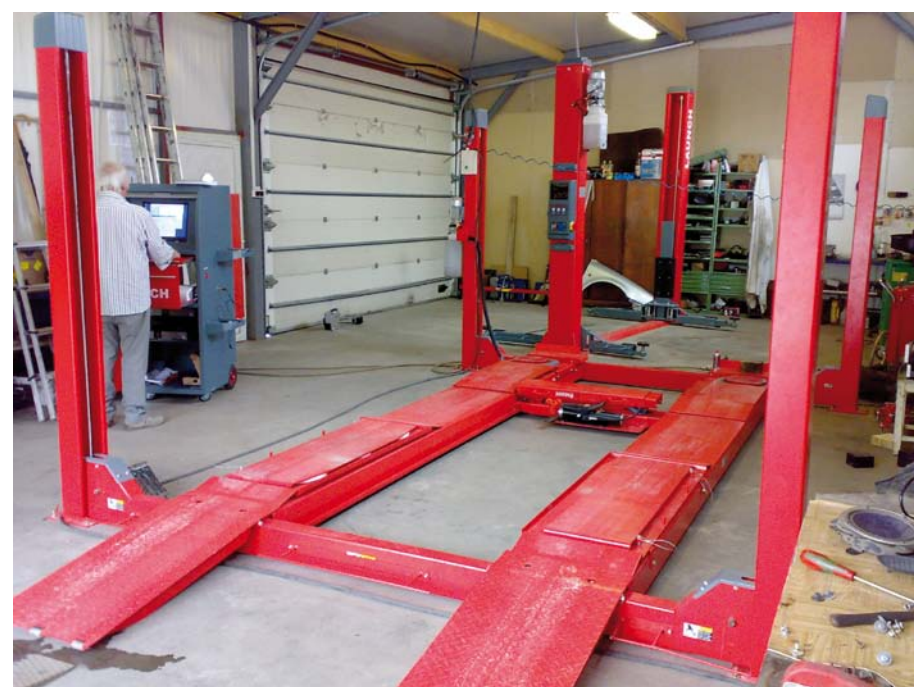
PODNOŚNIK CZTEROKOLUMNOWY W SWEJ PODSTAWOWEJ FUNKCJI ZASTĘPUJE KLASYCZNE STANOWISKO KANAŁOWE
