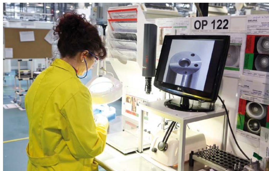
KONTROLA JAKOŚCI WYKONANIA OTWORÓW WIELOKROTNIE CIENSZYCH OD LUDZKIEGO WŁOSA WYMAGA SPECJALNYCH PRZYRZĄDÓW OPTYCZNYCH I ELEKTRONICZNYCH
