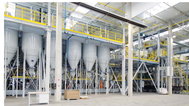
PODSTAWĄ PRODUKCJI FINALNYCH JEST NAJNOWOCZESNIEJSZA NA ŚWIECIE AUTOMATYCZNA MIESZALNIA MAS CIERNYCH. MOGĄCA REALIZOWAĆ DOWOLNE ICH RECEPTURY
