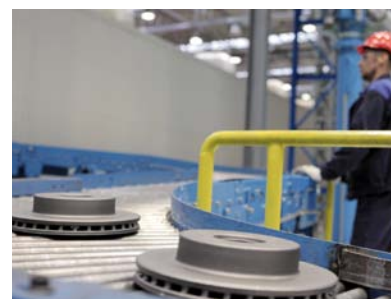
SUROWE ODLEWY OSTUDZONE I OCZYSZCZONE Z FORMIERSKIEGO PIASKU AUTOMATYCZNIE OPUSZCZAJĄ LINIĘ PRODUKCYJNĄ...
