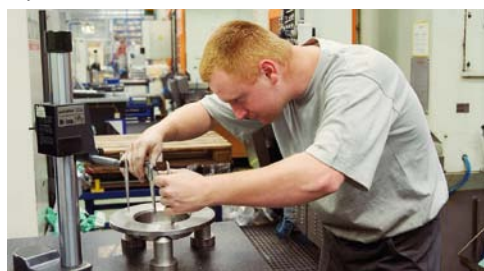
OSTATECZNY KSZTAŁT UZYSKUJE TARCZA PO AUTOMATYCZNEJ OBRÓBKCE SKRAWANIEM, A JEJ JAKOŚĆ KONTROLOWANA JEST BARDZO DOKŁADNYM SPRZĘTEM POMIAROWYM
