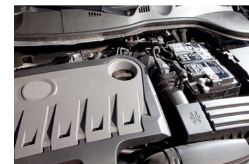
ZABUDOWA AKUMULATORA START-STOP W KOMORZE SILNIKOWEJ SAMOCHODU
