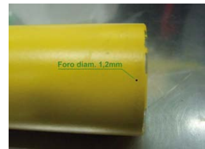
DODATKOWY OTWÓR O ŚREDNICY 1,2 MM POTRZEBNY PRZY DEMONTAŻU ZEWNĘTRZNEGO PIERŚCIEŃ BLOKUJĄCEGO
