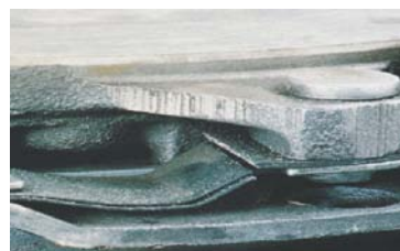
ODKSZTAŁCENIE SPRĘŻYN STYCZNYCH TARCZY DOCISKOWEJ SPRZĘGŁA Z POWODU WIBRACJI INNYCH CZĘŚCI UKŁADU NAPĘDOWEGO
