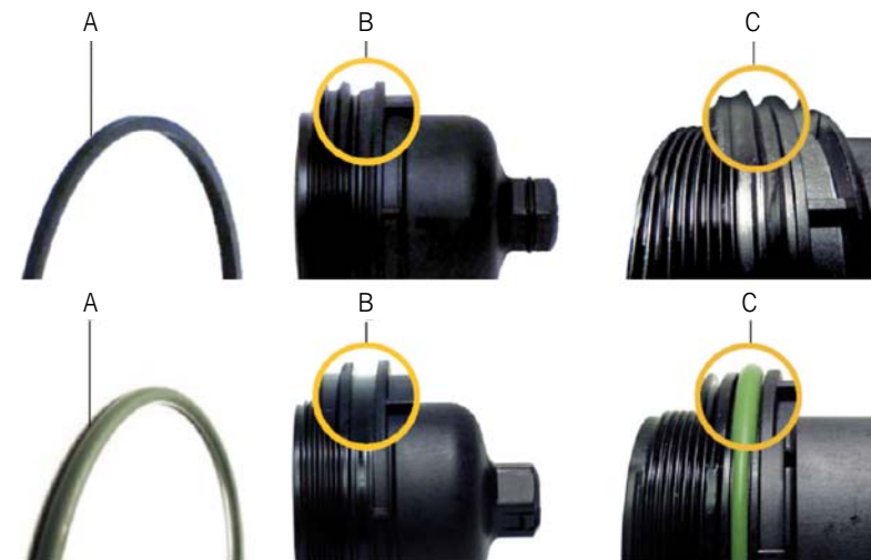
ODMIENNE USZCZELNIENIE FILTRÓW W RÓŻNYCH GENERACJACH SILNIKÓW: U GÓRY Z USZCZELKĄ O PROSTOKĄTNYM PRZĘKROJU DO MODELI EURO 4 I EURO 5, U DOŁU Z USZCZELKĄ O PRZĘKROJU OKRĄGŁYM DO MODELI EURO 6. A – USZCZELKA, B – PROFIL ROWKA POKRYWY, C – UŁOŻENIE USZCZELKI W ROWKU
