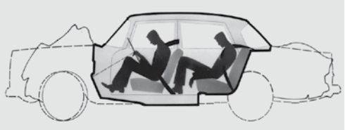
STWORZONA PRZEZ KONSTRUKTORÓW MERCEDESA W POŁOWIE UBIEGŁEGO WIEKU I OBOWIAZUJĄCA DO DZISIAJ KONCEPCJA PODZIAŁU NADWOZIA NA STREFY PODATNE I SZTYWNE
