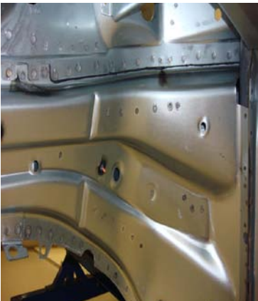
STREFY KONTROLOWANEGO ZGNIOTU W ZMODERNIZOWANYCH PODŁUŻNICACH VOLVO
