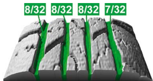
POMIARÓW GŁĘBOKOŚCI ROWKÓW DOKONUJE SIĘ RÓWNOCZEŚNIE W CZTERECH OBWODOWYCH PASACH BIEŻNIKA, A UZYSKANE WYNIKI PORÓWNYWANE SĄ Z DANymi WZORCOWYMI
