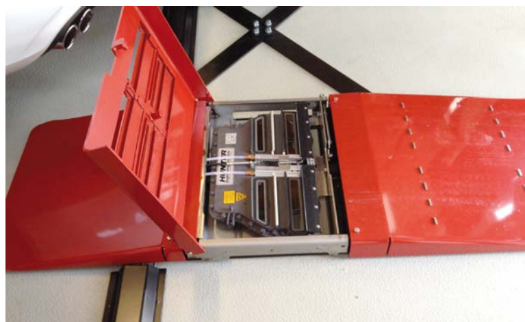
TRÓJWYMIAROWY OBRAZ RZEŻBY BIEŻNIKA TWORZĄ WSPÓLNIE CYFROWE KAMERY I LASEROWE LIDARY, A NADMUCH SPRĘŻONEGO POWIETRZA USUWA ZANIECZYSZCZENIA Z ROWKÓW
