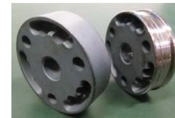
RYS. 6. SUROWY TŁOK EMMETEC DO SAMODZIELNEGO WYKONCZENIA (MOŻNA GO ŁATWO DOPASOWAĆ DO DOWOLNEGO PIERŚCIEŃCA)
