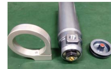
RYS. 9. ZBIORNIK EMMETEC Z PODWÓJNYM SYSTEMEM REGULACJI: ŻŁOTA ŚRUBA ZAMYKA ZAWÓR IGŁOWY, A CZARNA NAKRĘTKA WSTĘPNIE NAPINA SPRĘŻYNĘ
