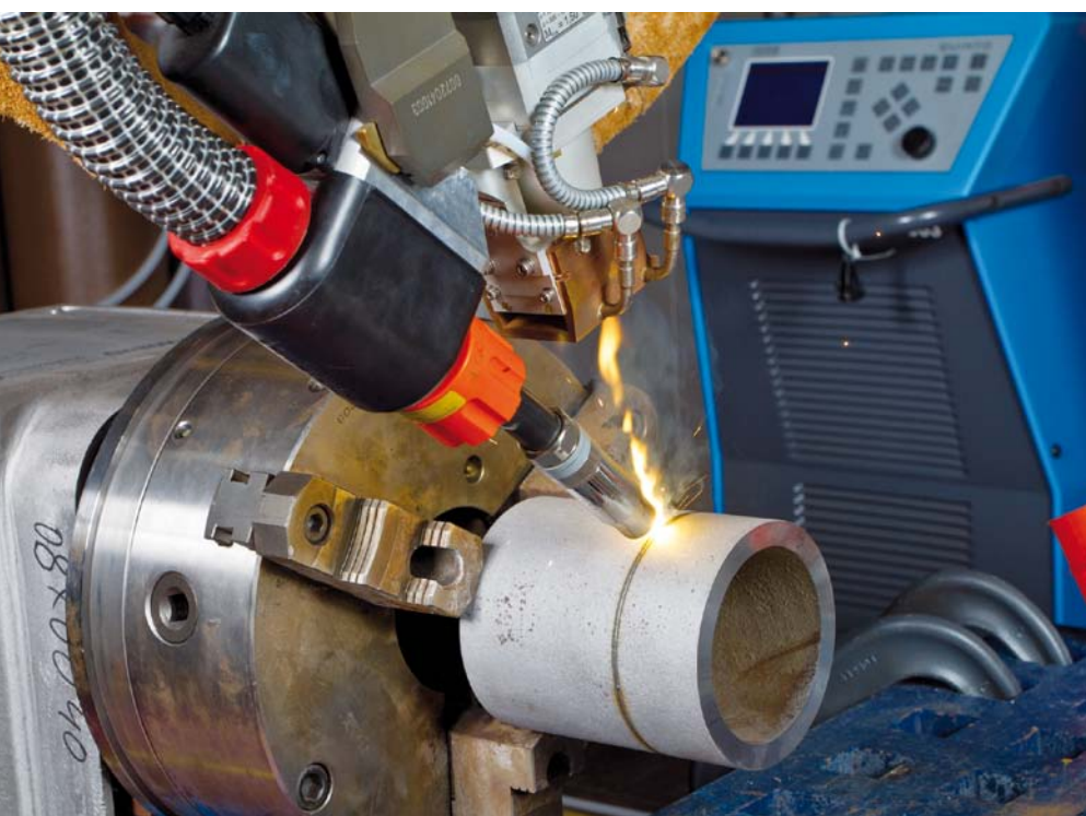
URZĄDZENIE HŁAW FIRMY GENERAL ELECTRIC Z LASEREM O MOCY 20 kW
