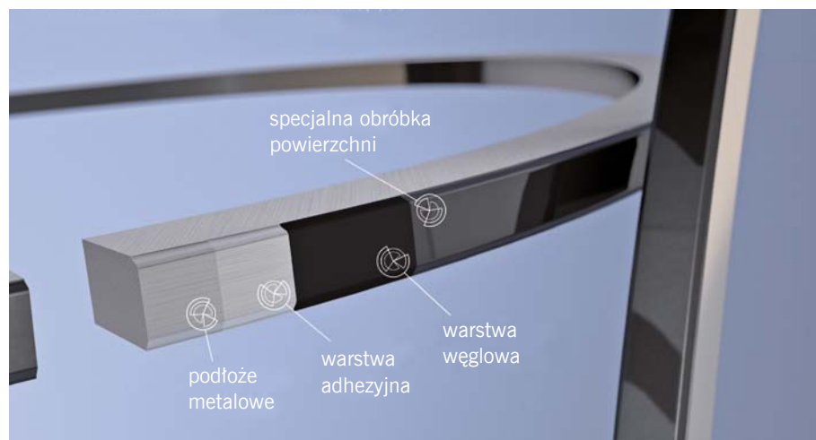
PIERŚCIEŃ TŁOKOWY Z POWŁOKĄ DUROGLIDE® ODZNACZAJĄ SIĘ ZMNIEJSZONYM TARCIEM I ZWIĘKSZONĄ TRWAŁOŚCIĄ
