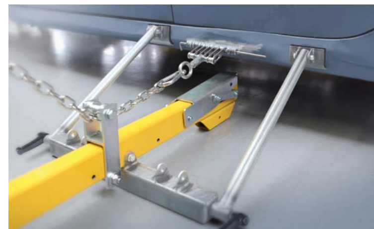
PODSTAWĘ WARSZTATOWYCH PRZYCHODÓW STANOWIĄ OBECNIE TZW. NAPRAWY ŚRĘDNE, CZYLI USUWANIE WGNIECIEŃ KAROSERYJNEGO POSZYCIA
