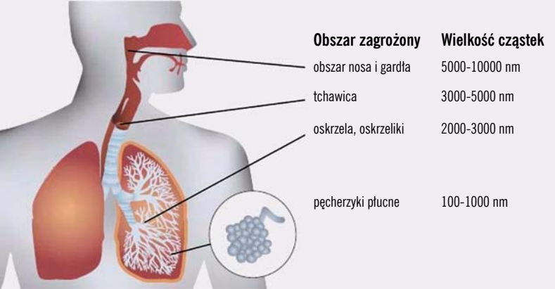
rys. 3. ZAGROŻENIE UKŁADU ODDECHOWEGO CZŁOWIEKA SZKODLIWYM DZIAŁANIEM CZĄSTEK STAŁYCH. GŁĘBOKOŚĆ ICH WNIKANIA ZALEŻY OD ŚREDNICY
