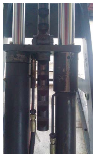
MECHANICZNE, ZĘBATKOWO-ZAPADKOWE ZABEZPIECZENIE POMOSTU PODNOŚNIKA NOŻYCOWEGO
