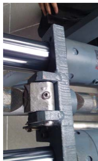
ZAPADKI NA LISTWIE ZĘBATEJ ODBLOKOWYWANE PNEUMATYCZNIE
