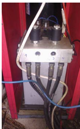
POMPA HYDRAULICZNA Z ZABEZPIEZAJĄCYMI ZAWORAMI JEDNOKIERUNKOWYMI
