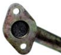
RYS. 2. KANAŁ POWROTNY ZAŚLEPIONY NAGAREM
