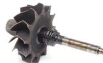
RYS. 1. PIERŚCIEŃ USZCZELNIĄCY ZABLOKOWANY SKOKSOWANYM OLEJEM
