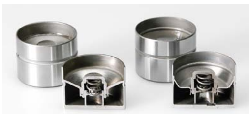
PRZEKRÓJ HYDRAULICZNEGO POPYCHACZA SZKLANKOWEGO
