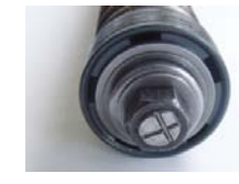
RYS. 11. ZABEZPIECZENIE NAKRĘTKI PRZED SAMOCZYNNYM ODKRĘCANIEM SIĘ PRZEZ ROZKLEPIANIE KOŃCÓWKI TŁOCZYSKA
