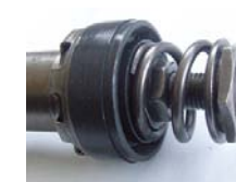
RYS. 10. ZAWÓR ROZCIĄGANIA Z DODATKOWĄ NAKRĘTKĄ BLOKUJĄCĄ TŁOK NA TŁOCZYSKU
