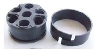
RYS. 12. TŁOK BILSTEIN 36 MM STOSOWANY W KOLUMNACH MCPHERSON SAMOCHODÓW MERCEDES BENZ
