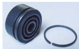
RYŚ. 15. TŁOK Z ŻELIWNYM PIERŚCIENIEM USZCZELNIAJĄCYM JEST PROSTYM I NIEZAWODNYM ROZWIĄZANIEM DLA CIĘŻKICH POJAZDÓW UŻYTKOWYCH
