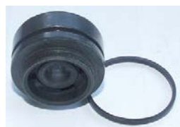
RYŚ. 16. TŁOK USZCZELNIONY O-RINGIEM O PRZĘKOJU KWADRATOWYM (MCPHERSON VOLKSWAGEN GOLF)
