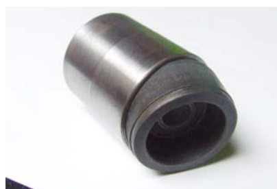
RYŚ. 18. NARZĘDZIE MONTAŻOWE EMMETEC UŁATWIAJĄCE WPROWADZENIE TŁOKA Z PIERŚCIENIEM DO CYLINDRA AMORTYZATORA
