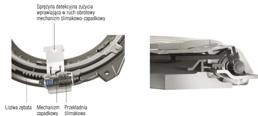
Mechanizm ślimakowo-zapadkowy stosowany w sprzęgłach firmy Valeo
