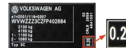
RYS. 8. INFORMACJA O WARTOŚCI ZADYMIEŃ SPALIN ZMIERZONEJ W RAMACH BADAŃ HOMOLOGACYJNYCH WG NORMY EURO 6 DLA NOWEGO SAMOCHODU MARKI VOLKSWAGEN PASSAT VARIANT 2.0 TDI O MOCY 150 KM Z ROKU 2014 (MODEL WPROWADZONY DO SPRZEDAŻY JESIENIĄ 2014 R.)
