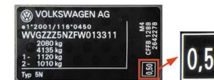
RYS. 7. INFORMACJA O WARTOŚCI ZADYMIEŃ SPALIN ZMIERZONEJ W RAMACH BADAŃ HOMOLOGACYJNYCH WG NORMY EURO 5 DLA NOWEGO SAMOCHODU MARKI VOLKSWAGEN TIGUAN 2.0 TDI O MOCY 140 KM Z ROKU 2014 R.
