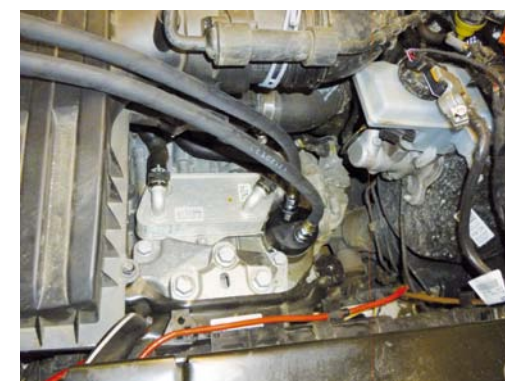
PODŁĄCZENIE URZĄDZENIA DO SKRZYNI BIEGÓW Z UŻYCIEM ADAPTERÓW
