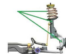
RYŚ. 2. W ZAWIESZENIU TYPU MCPHERSON SPRĘŻYNA, AMORTYZATOR I PIASTA KOŁA PORUSZAJĄ SIĘ, WYKONUJĄC TEN SAM SKOK Z TĄ SAMĄ PRĘDKOŚCIĄ
