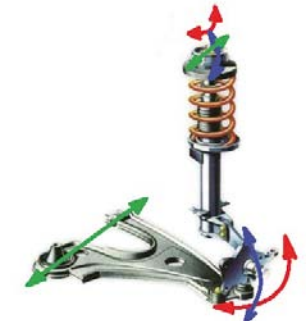
RYŚ. 6. PIASTA KOŁA W ZAWIESZENIU MCPHERSON MOŻE WYKONYWAĆ RUCH DO PRZODU I DO TYŁU (PRZYSPIESZENIE I HAMOWANIE), DO GÓRY I W DÓŁ (TOCZENIE) ORAZ OBRACAĆ SIĘ WOKÓŁ OSI ZWROTNICZY (SKRĘT KOŁA), CZYLI POŁĄCZENIE AMORTYZATORA Z PODWOZIEM MUSI BYĆ PODATNE W WYMIENIONYCH KIERUNKACH
