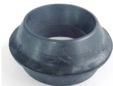
RYŚ. 9. GUMOWY WSPORNIK Z METALOWYM RDZENIEM ROZDZIELA PUNKTY PRZYŁOŻENIA SIŁ SPRĘŻYNY I AMORTYZATORA
