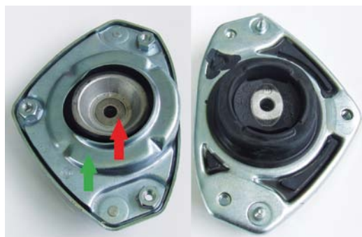
RYŚ. 10. W PRZYPADKU WSPORNIKA GUMOWO-METALOWEGO SIŁA AMORTYZATORA KONCENTRUJE SIĘ W ŚRODKU (CZERWONA STRZAŁKA), A SIŁA SPRĘŻYNY – NA BRZEGACH ELEMENTU (ZIELONA STRZAŁKA)
