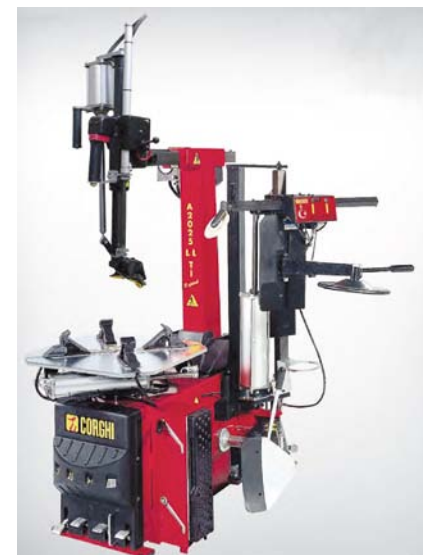
MONTAŻOWNICA ZE STOPKĄ TYPU BEZŁYŻKOWEGO (KAT. VI)
