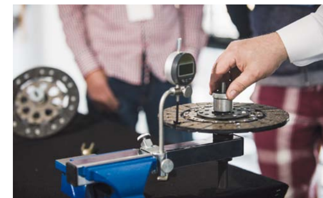
POMIAR BICIA TARCZY SPRĘGŁOWEJ WERYFIKUJĄCY JEJ EKSPLOATACYJNĄ PRZYDATNOŚĆ
