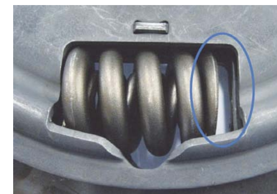
RYS. 7. KONSTRUKCJE WSPÓŁCZESNYCH WIELOSTOPNIOWYCH TŁUMIKÓW DRGAŃ SKRĘTNYCH W TARCZACH SPRZĘGŁOWYCH CZĘSTO WYMAGAJĄ LUZU WSTĘPNEGO
