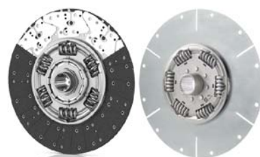
RYS. 2. PODSTAWOWYM ZADANIEM, JAKIE SPEŁNIA W TARCZY SPRZĘGŁOWEJ TŁUMIK DRGAŃ SKRĘTNYCH, JEST PRZENIESIENIE CZĘSTOTLIWOŚCI DRGAŃ WŁASNYCH SILNIKA POZA OBSZAR CZĘSTOTLIWOŚCI REZONANSOWEJ SKRZYNI BIEGÓW ORAZ OBNIŻENIE AMPLITUDY TYCH DRGAŃ
